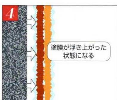
化学反応により塗膜が軟化湿潤した状態になります。
