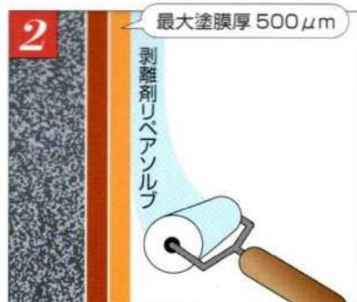
旧塗膜の上からスプレーガン、ローラー、刷毛等を使用し、剥離剤を塗布します。
