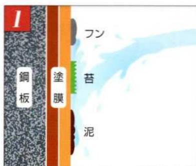
塗布面に付着している泥・苔・鳥の糞等を除去して下さい。汚れた状態は、剥離剤の浸透を妨げ、剥離不良につながります。
