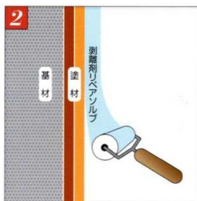
旧塗膜の上からスプレーガン、ローラー、刷毛等を使用し、剥離剤を塗布します。
